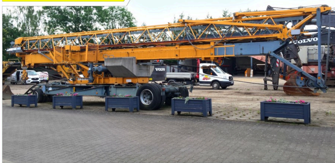
Wieża dźwigowa LIEBHERR 32TT
