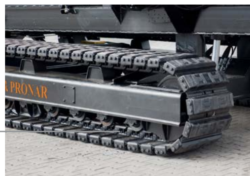
Układ hydraulicznego unoszenia ramy MPB 20.55g pozwala wy poziomować maszynę do pracy na pochyłościach wzdłużnych i zwiększa prześwit ułatwiając pokonywanie nierównego terenu.
