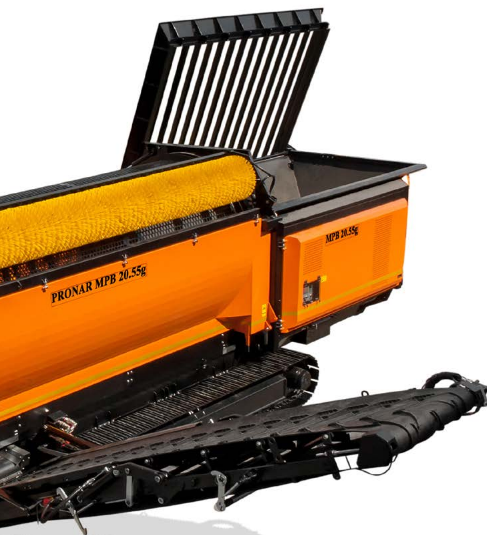
Układ hydraulicznego unoszenia ramy MPB 20.55g pozwala wy poziomować maszynę do pracy na pochyłościach wzdłużnych i zwiększa prześwit ułatwiając pokonywanie nierównego terenu.
