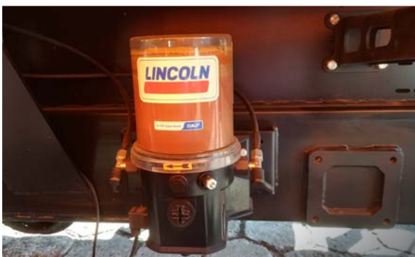
Pompa centralnego smarowania zapewnia dobrą kondycję smarną najważniejszych elementów maszyny. Dostępna w dwóch rozmiarach.
