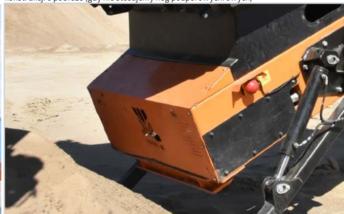
Podpora w tylnej części przenośnika chroni osłony przed uszkodzeniem przy opieraniu konstrukcji o podłoże (gdy nie stosujemy nóg podporowych)
