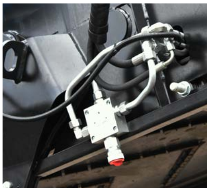
Regulacja prędkości przesuwu taśmy podajnika
