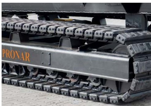
Gumowe nakładki na łańcuchnice chronią podłoże przed porysowaniem stalowymi klepkami.
