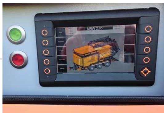
Dotykowy panel sterujący wszystkimi funkcjami maszyny
