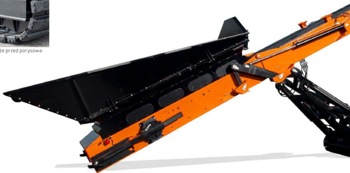
Podpora w tylnej części przenośnika chroni osłony przed uszkodzeniem przy opieraniu konstrukcji o podłoże (gdy nie stosujemy nóg podporowych)
