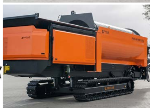
Układ hydraulicznego unoszenia ramy MPB 20.55g pozwala wy poziomować maszynę do pracy na pochyłościach wzdłużnych i zwiększa prześwit ułatwiając pokonywanie nierównego terenu.
