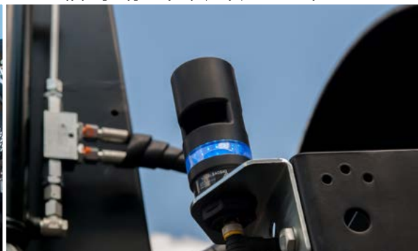
Wielofunkcyjny kogut sygnalizuje tryb pracy (przesiewanie/jazda)
