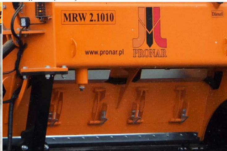
Okna rewizyjne komory roboczej
