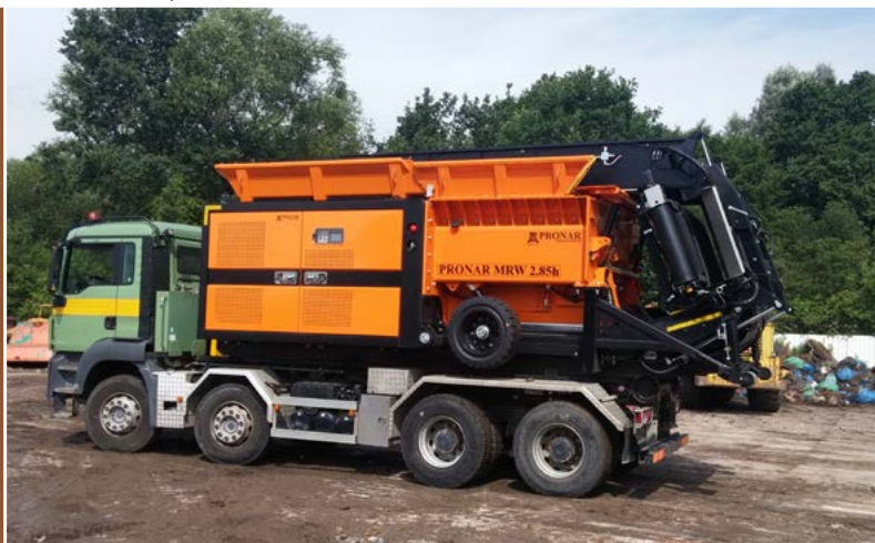
MRW 2.85h - transport na nośnikach z ramą hakowca
