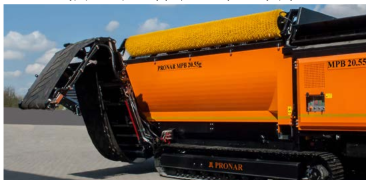
Przełoźniki składają się na zewnątrz maszyny co pozwoliło uzyskać mniejszą wysokość
