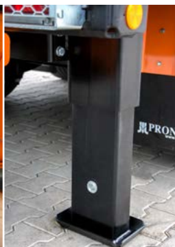
Hydrauliczne tylne nogi podporowe poprawiają stabilność maszyny podczas pracy
