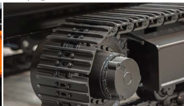
Napęd łańcuchowy pozwala na przemieszczanie po placu roboczym bez dodatkowych ciągników
