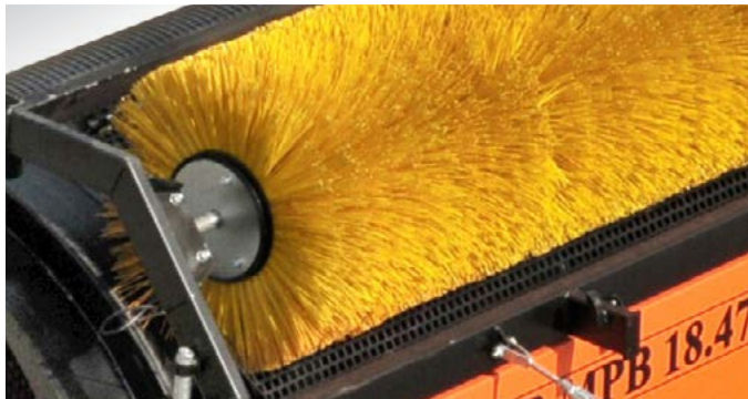
Szczotka czyszcząca bęben opuszczana i podnoszona hydraulicznie
