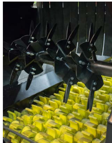
Wał rozrzucający materiał na pokład
