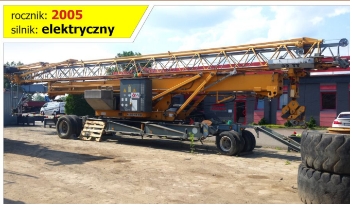
Wieża dźwigowa LIEBHERR 32TT
