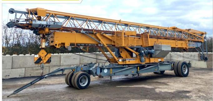
Wieża dźwigowa LIEBHERR 32TT
