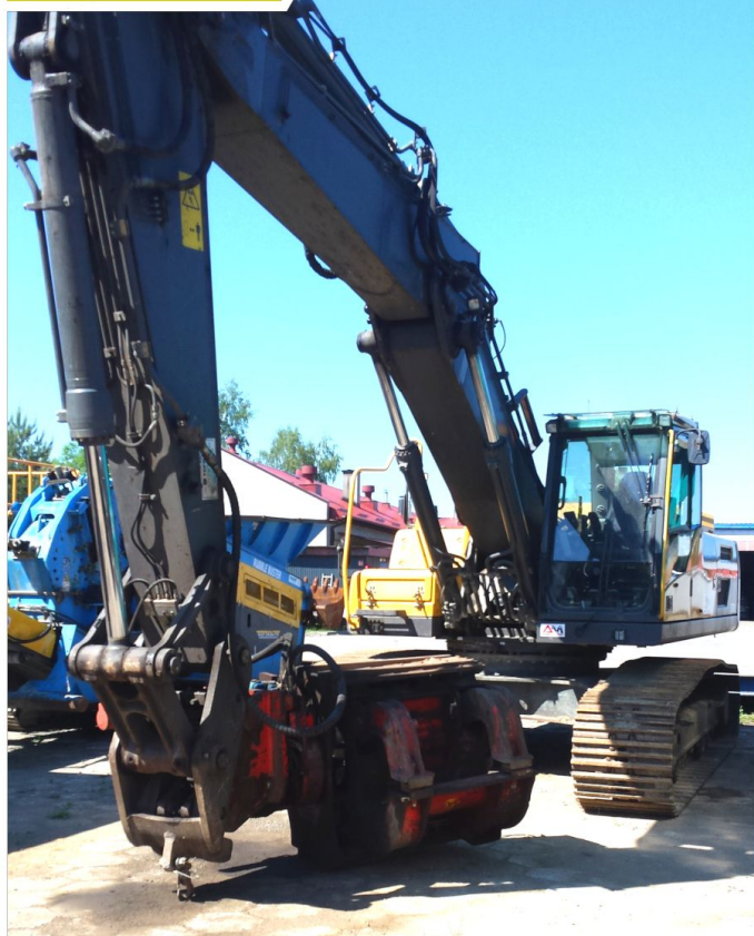
Koparka gąsienicowa VOLVO EC300 DL z palownicami
