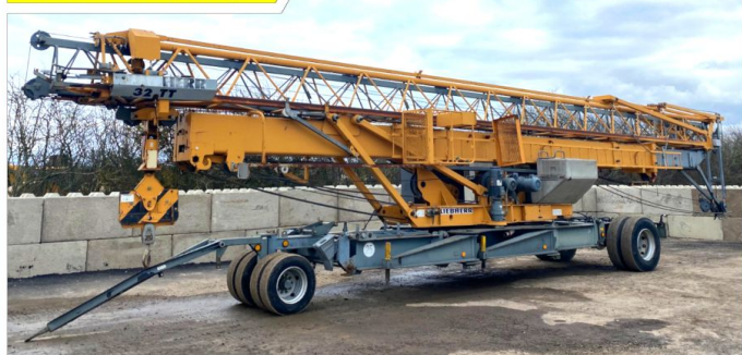
Wieża dźwigowa LIEBHERR 32TT
