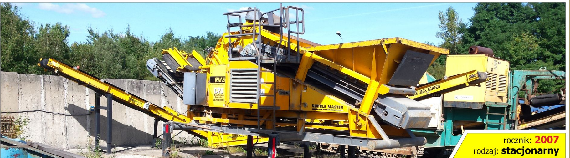
Zestaw stacjonarny Rubble Master : kruszarka udarowa RM 60 z przesiewaczem CS2500
